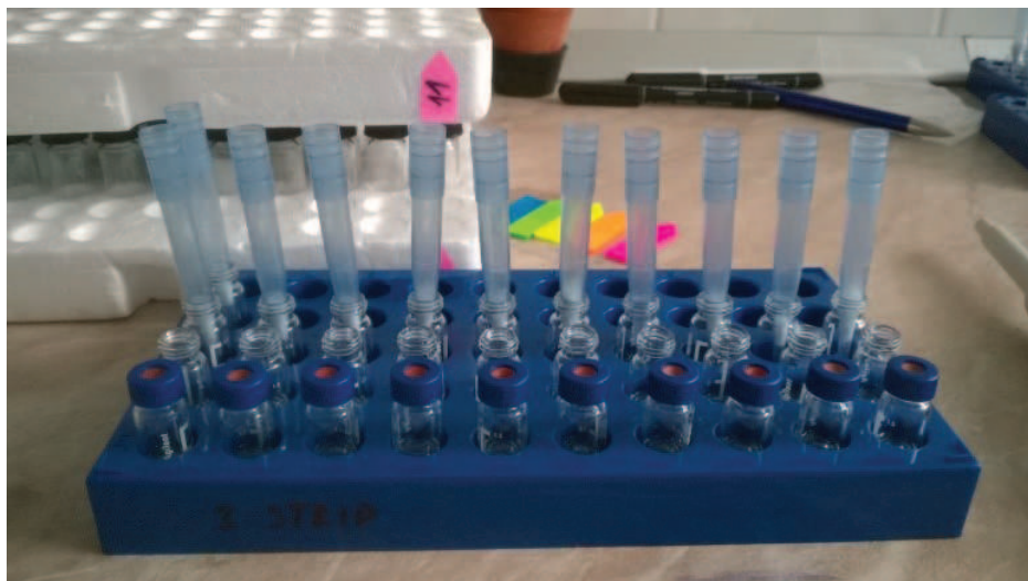
Obr. č. 15: Filtrace extraktu.
