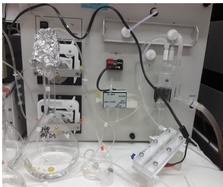
Obr. 3.7: Použitá aparatura pro elektrochemické generování těkavých sloučenin antimonu a jejich detekci pomocí AFS
