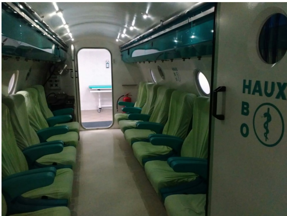
Obr. 3 – hyperbarická komora – uvnitř komory (zdroj: archiv autora)
